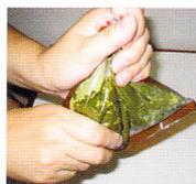
②粉末と液体を袋の中で混ぜ合わせ、マヨネーズ状になるまで両手で本体をよくもみ込み、しっかりと混ぜたら袋ごと43℃以下のお湯に浸して少し温めます。
